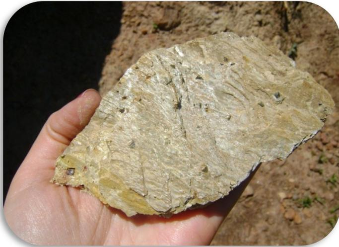
Detalhe do metadiamicito estéril com magnetita
