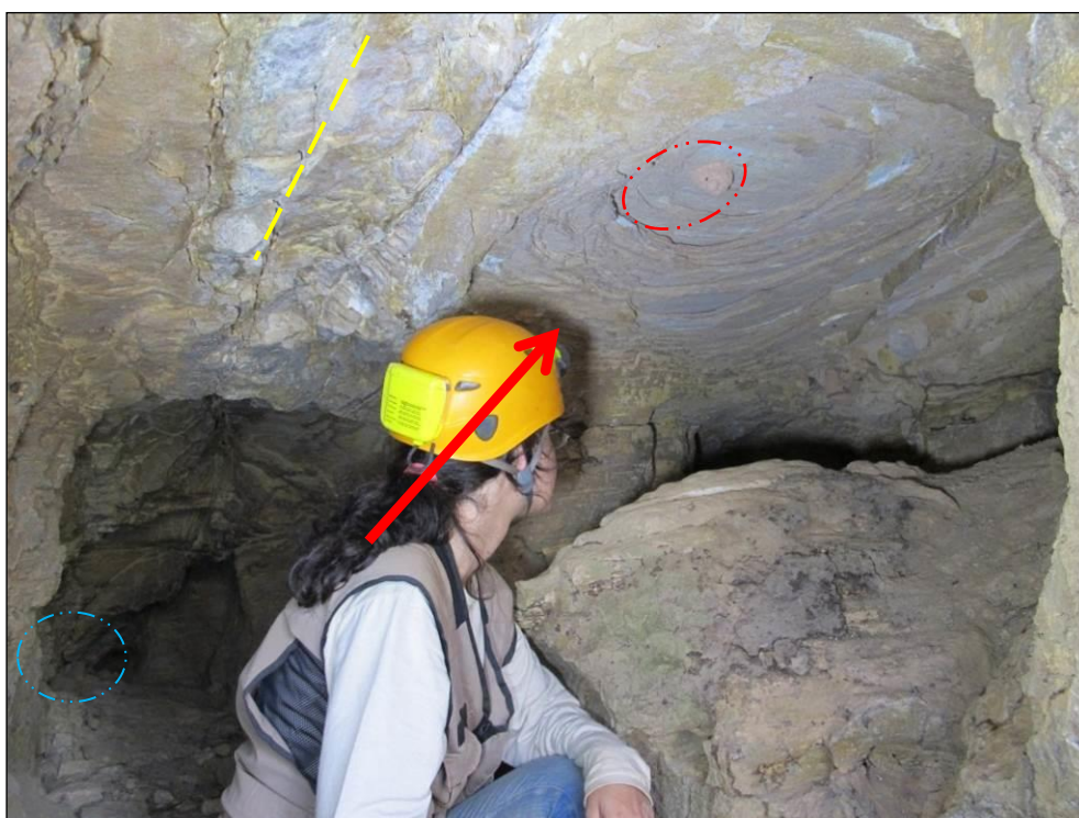
Foto 8.125 - Terço médio e final da cavidade CM-27. A linha amarela demarca o traço da fratura preenchida por quartzo; no teto, em vermelho, está indicada a presença da cúpula de teto e ao fundo, em azul, é mostrada a localização do canalículo. Fonte: Brandt, 2012b.
