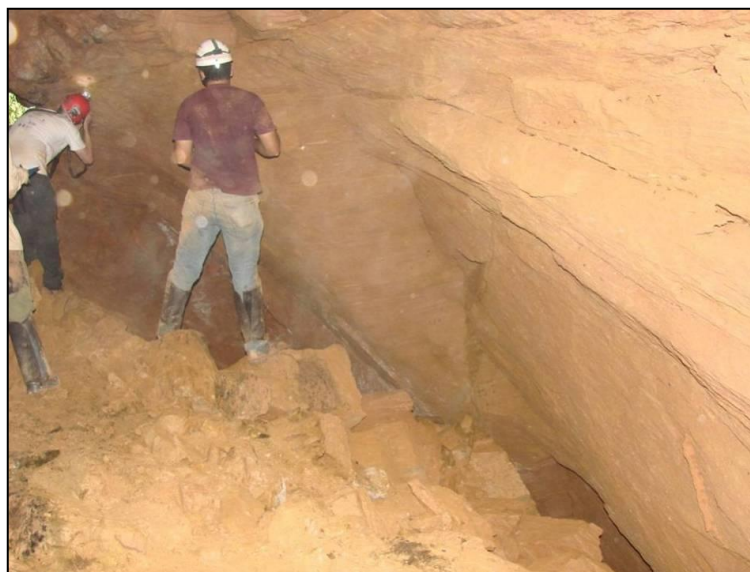
Foto 8.130 - Blocos abatidos de metadiamiccitos estéril concentrados na Caverna CM-07. Fonte Brandt. 2012b.
