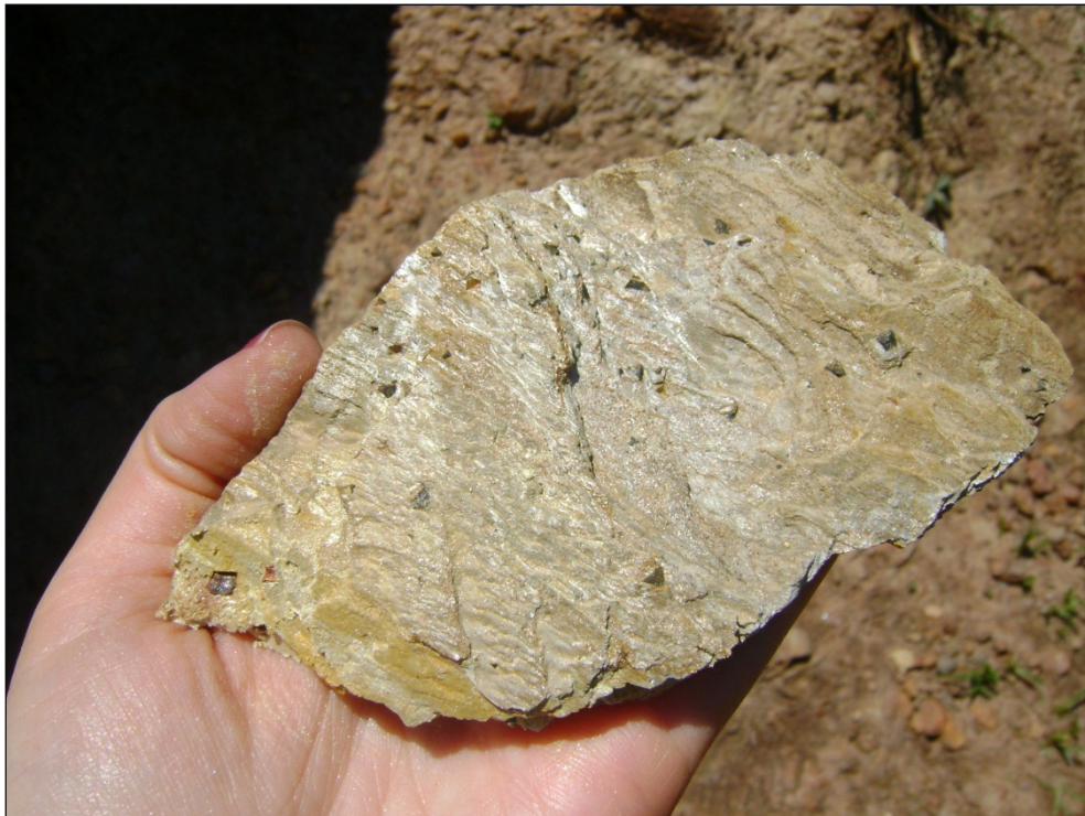
Foto 5.2 - Detalhe do metadiamictito estéril com magnetita disposta no plano da foliação S1
