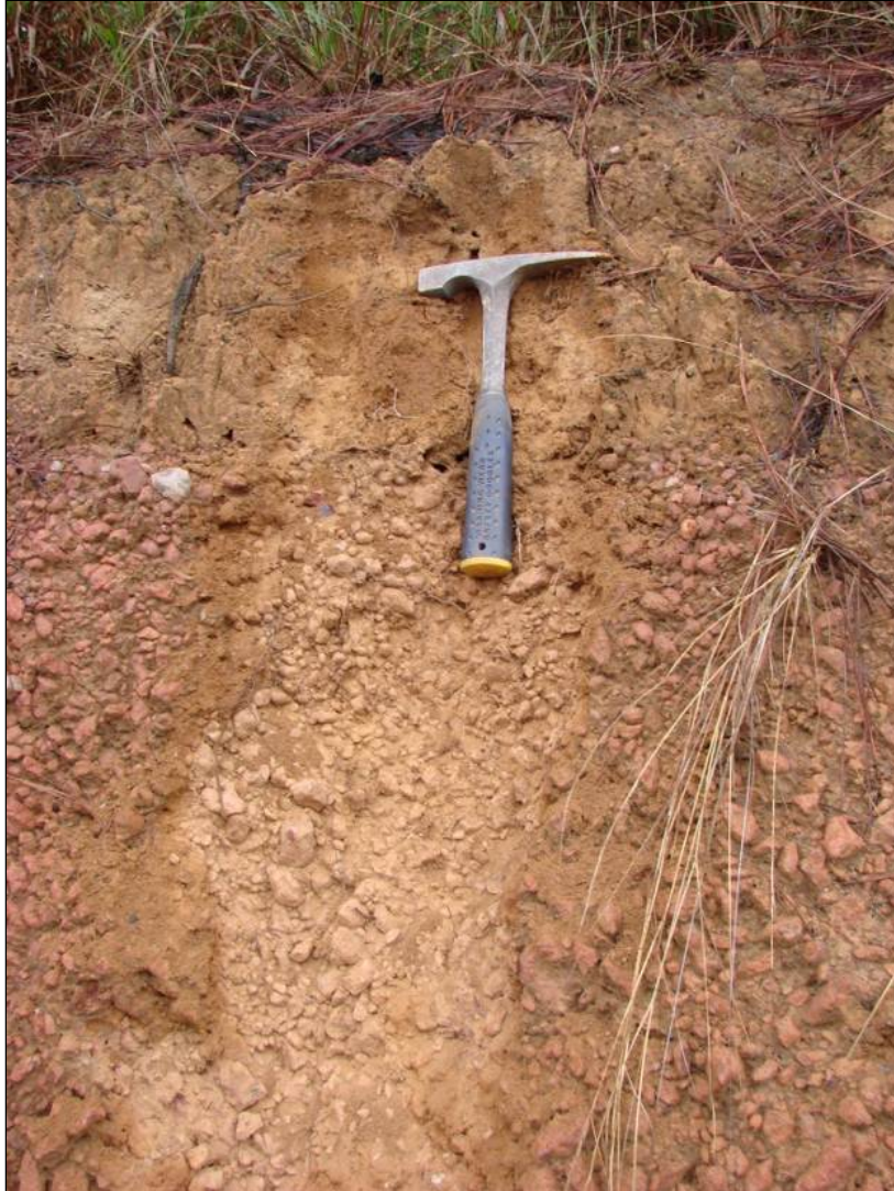
Foto 9.31 - Perfil de Cambissolo Háplico na baixa vertente de vale interceptado pela adutora de Irapé e linha de transmissão. Imediatamente acima se observa a ocorrência de Latossolo Vermelho-Amarelo
