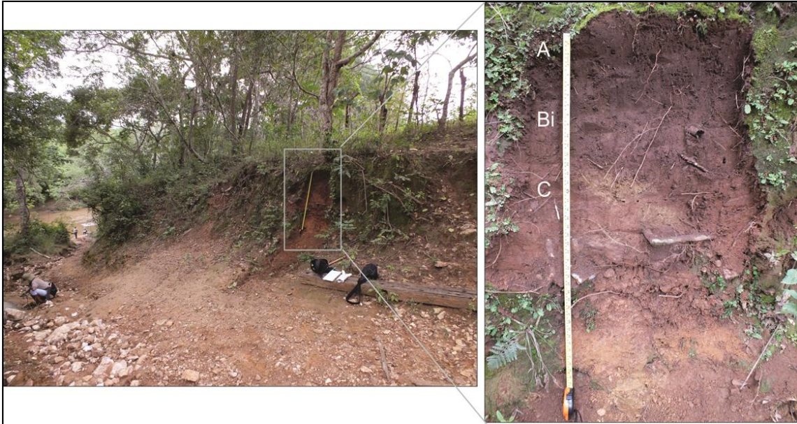
Foto 9.48 - Perfil de Cambissolo Flúvico localizado na vertente da margem direita do rio Vacaria Elaboração, IC Ambiental.
