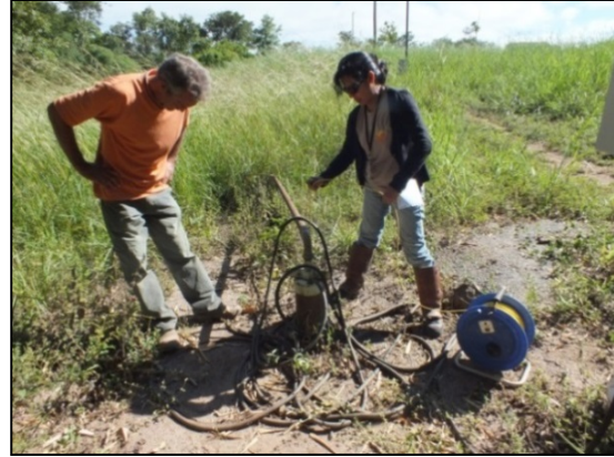
Foto 11.2 - Medição de vazão no poço próximo ao córrego Andrequicé, campanha de 2013
