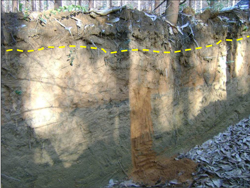
Foto 9.24 - Latossolo com estruturas bem desenvolvidas e formação de uma camada de matéria orgânica (tracejado amarelo) que ajuda manter a estabilidade dos agregados
