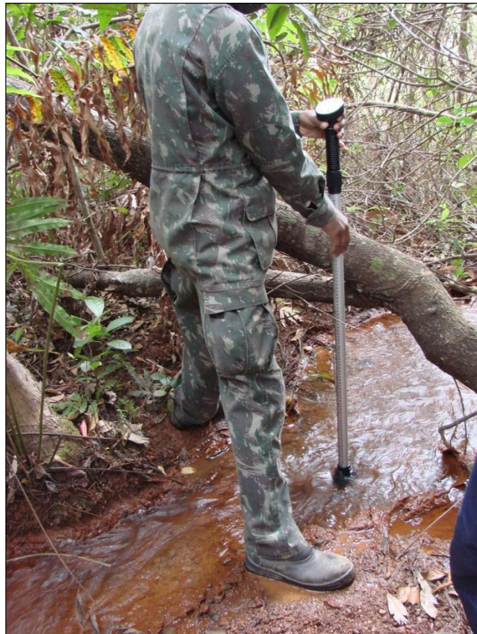
Foto 10.33 - Medição de vazão no córrego da Batalha
