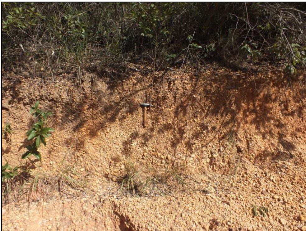
Foto 9.49 - Perfil de Cambissolo sobre cascalheira, com aproximadamente 1,50m de espessura Elaboração, IC Ambiental.
