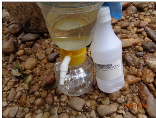
Foto 10.112 - Filtragem a vácuo dos metais dissolvidos no momento da coleta das amostras
