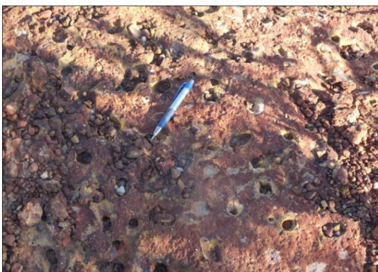
Foto 5.29 - Metadiamicrito intemperizado formando crosta laterítica
