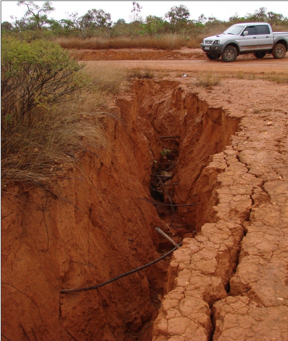
Foto 7.40 - Voçoroca na margem da estrada de Irapé, limite leste da área de estudo
