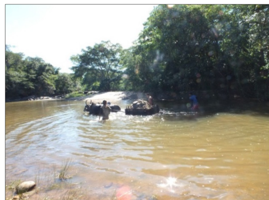
Foto 5.48 - Extração de areia de forma manual sendo retirada por carro de bois, à jusante da queda d'água
