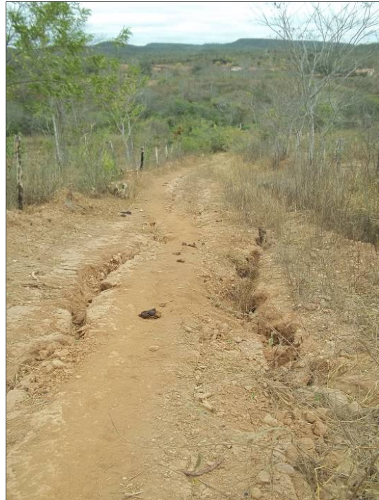
Foto 5.35 - Solo coluvionar silto-arenoso
