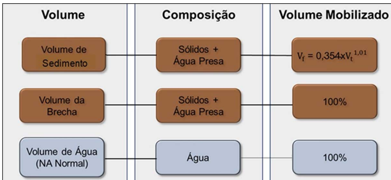
Figura 5.1 – Composição do hidrograma de ruptura em termos de volume.
