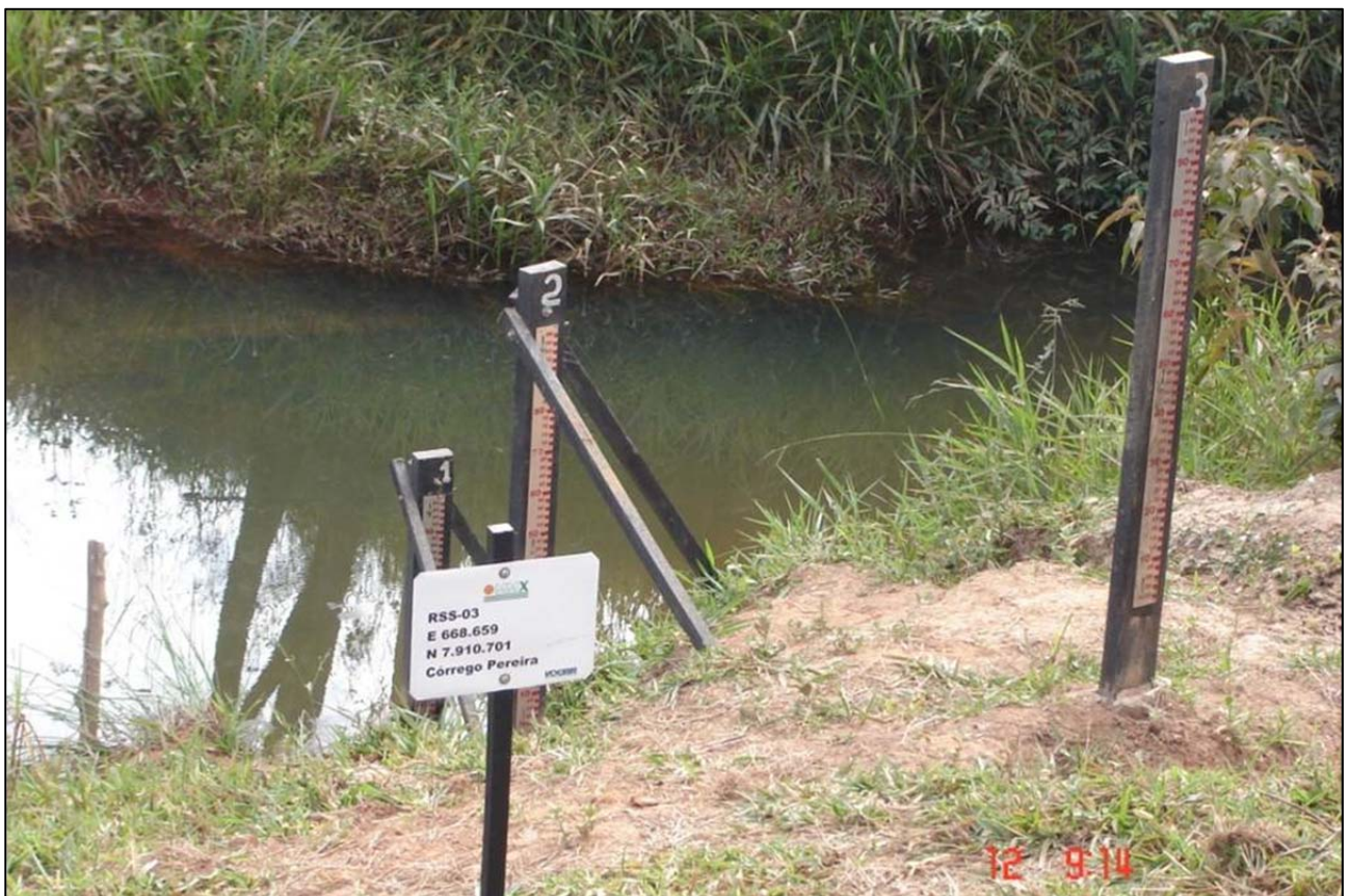
Figura 5.2.2.1 – Exemplo de estação fluviométrica.
