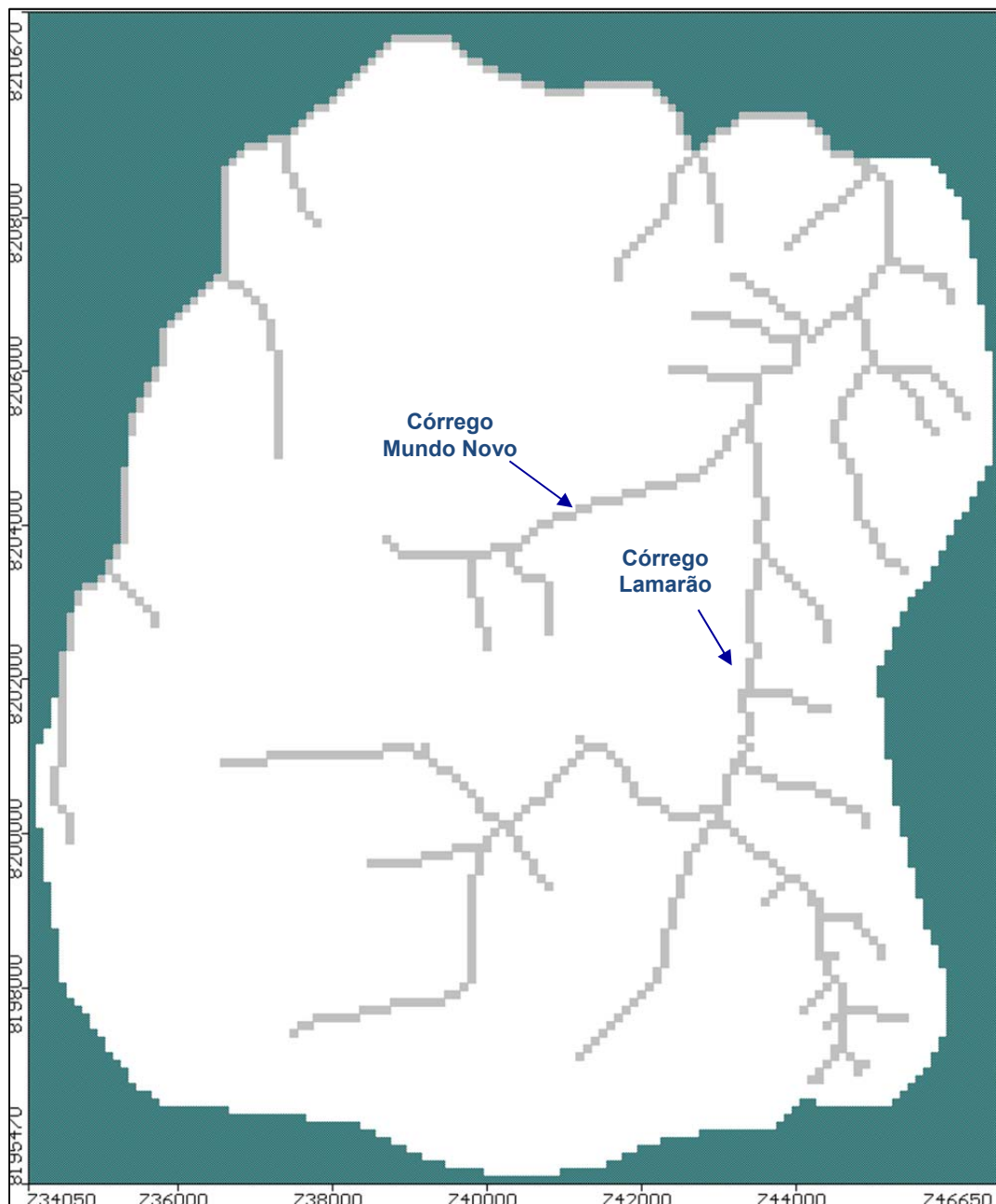
Figura 5.1.4 - Distribuição espacial das condições de contorno de "Carga Constante" e de "Drenos".
