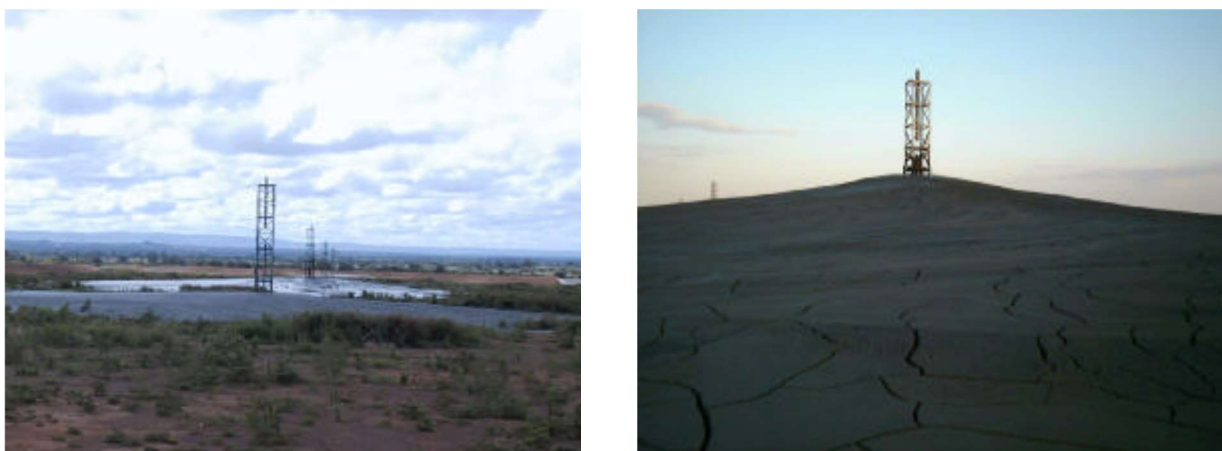
Figura 6.1.1.2.2 – Deposição de rejeito em pasta – PASTE, Bulyanhulu Gold Mine, Tanzânia.
