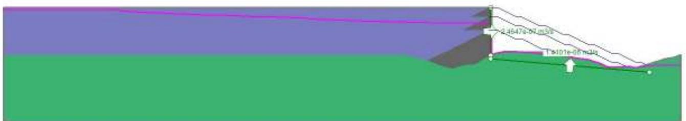
**Figura A.3 – Análise de Percolação – Barragem Final (EL. 915,00) – Seção Ombreira Direita**
