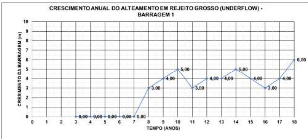
Figura 7.2.4.6 – Crescimento anual do maciço da Barragem 1
