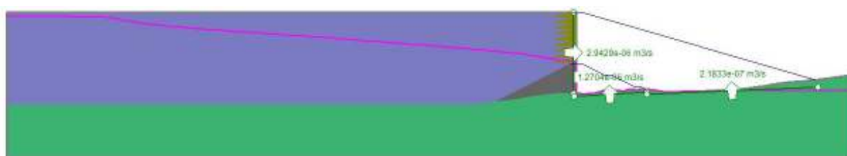
Figura 9.2.5.2.1 - Análise de Percolação – Barragem Final (EL. 935,00) – Fundo do Talvegue – Seção A-A
