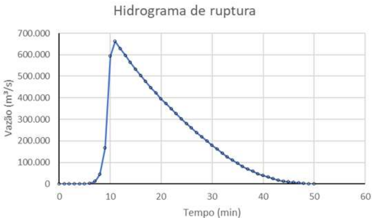
Figura 9.3 – Hidrogramas de ruptura resultante – Barragem 1.
