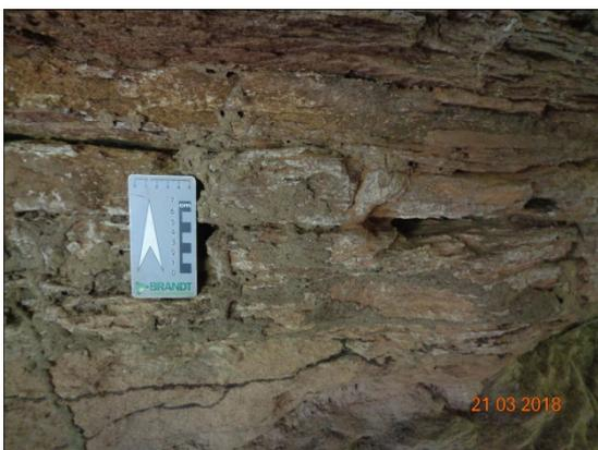
**Foto 3.4.2-1 - Aspecto do metadiamicrito observado na cavidade VAC\_06. É possível observar a foliação sub-horizontal da rocha, de dimensões centimétricas, intercaladas por porções vazias, de mesmas dimensões**
