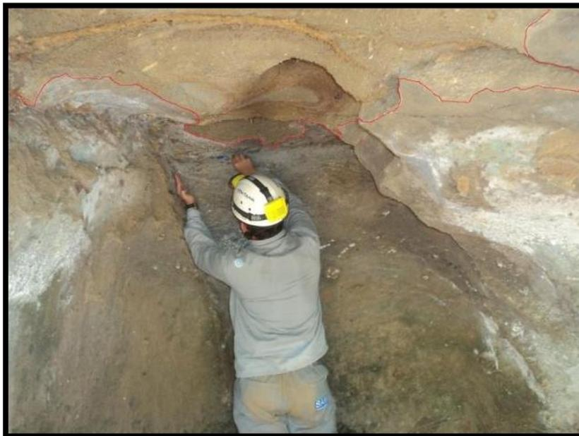
**AB VAC 14. Detalhamento do fraturamento dentro da reentrância e o contato diferenciando a compacidade rochosa, sinalizado pela linha vermelha na foto.**
