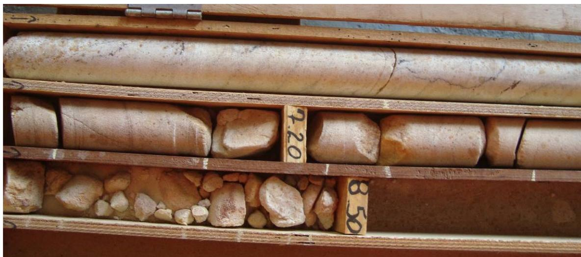
Sondagem e uma mesma rocha - quartzito, com trechos classificados como medianamente alterada (parte superior) e totalmente alterada (parte inferior).
