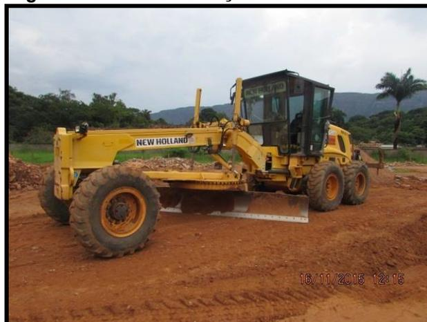
Motoniveladora em operação, com registro de vibração de  $V_{pi} = 1,167 \text{ mm/s}$  a  $5$  (cinco) metros e  $V_{pi} = 0,426 \text{ mm/s}$  a  $10 \text{ m}$  (dez) metros
