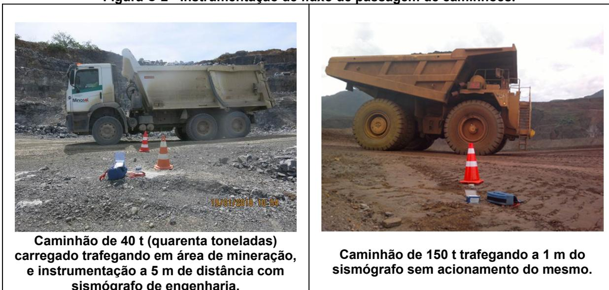
Caminhão de 40 t (quarenta toneladas) carregado trafegando em área de mineração, e instrumentação a 5 m de distância com sismógrafo de engenharia.
